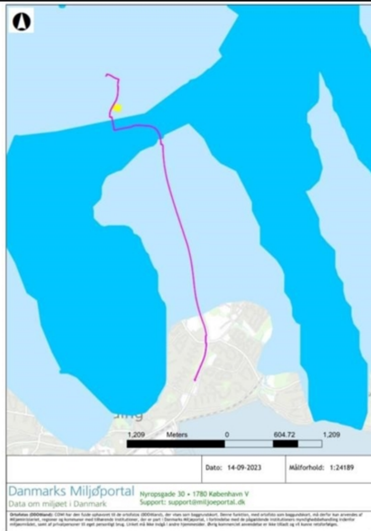
Figur 10 De lyseblå områder angiver områder med drikkevandsinteresser. De mørkeblå områder angiver områder med særlige drikkevandsinteresser. Den magenta linje angiver ledningstraceet.
