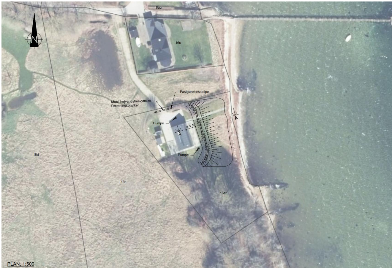
Figur 3.2: Plantegning af terrænhældning og dige (se vedlagte tegning Elv_A5_K24_0002 for flere detaljer). Baggrund: Flybillede forår 2023.
