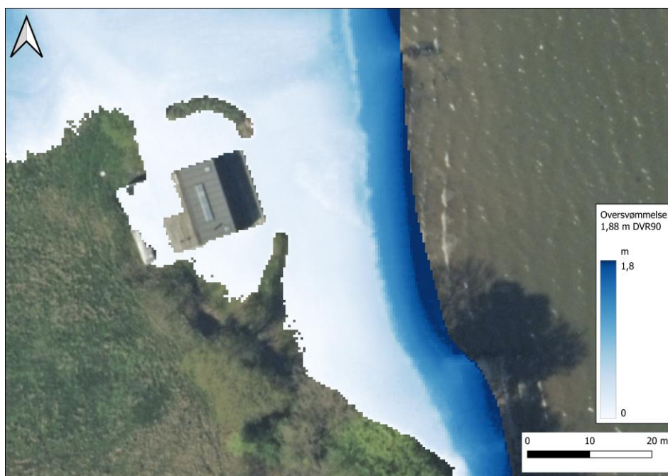
Figur 4.2: Oversvømmelse ved forhøjet vandstand svarende til Oktoberstormen 2023 (+1,88 m DVR90) ved Kolding Havn (SCALGO, 2024; Kystdirektoratet, 2024).
