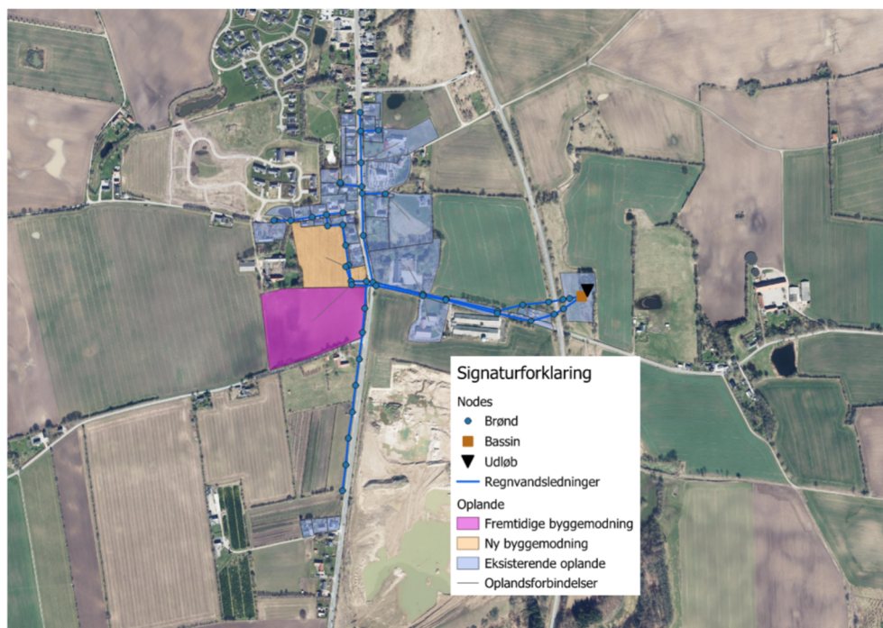
Figur 2-1: Eksisterende oplande samt placering af bassin RB-06-18 og udløb til Babrekær Grøft. Figuren viser også fremtidige byggemodninger.
