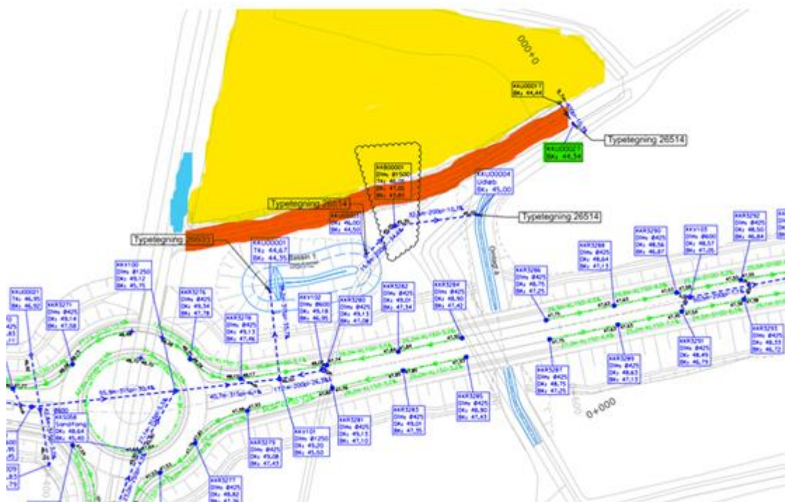
Figur 1: Oversigtskort med opland og udledningspunkt KKU00027. Rød linje markerer den nye markvej. Blå linje: Del af tidligere, nu privat vej. Gult: Markareal.
