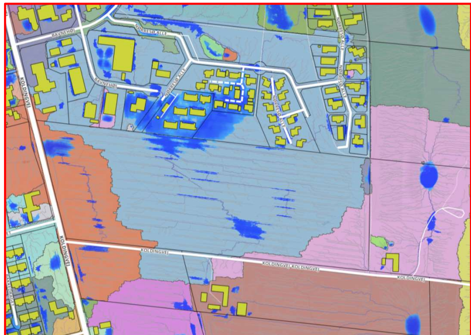
Figur 5-3 viser oplandsinddelingen under skybrud i dag, hvor opland B, C og D er ét stort opland, som afstrømmer mod nord.
