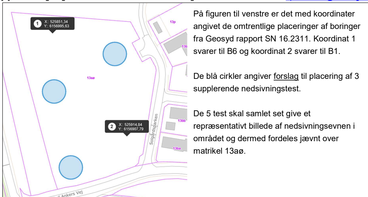
Figur 2: Placering af boring B1 og B6 samt forslag til placering af yderligere test.
