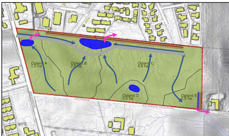
Figur 4: Overordnet princip for regnvandshåndtering inden for hele lokalplan området.
