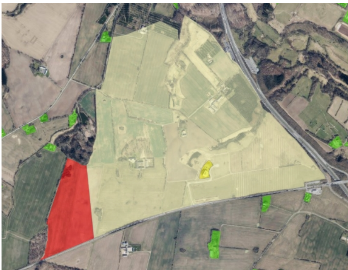
Figur 1: Den røde markering afgrænser området der fremover separatkloakeres. Den gennemsigtige gule markering viser det eksisterende kloakopland.
