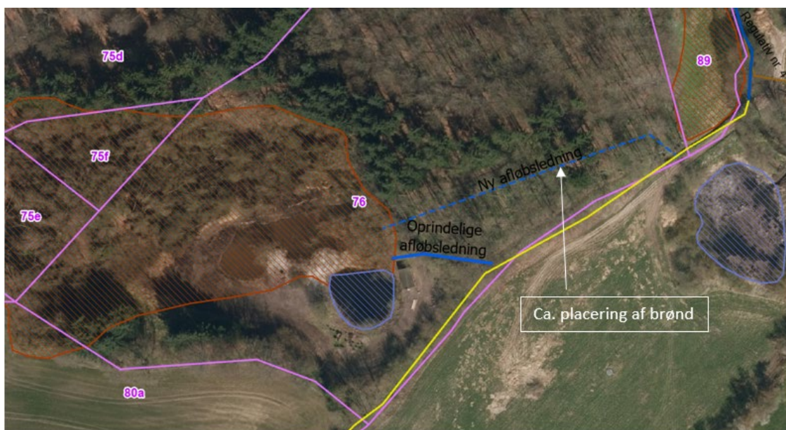
Luftfoto med markering af oprindeligt afløb fra moseområdet (blå streg), ny afløbsledning fra moseområdet (blå stiplede streg) og placeringen af en ny brønd (hvid pil og tekst).
