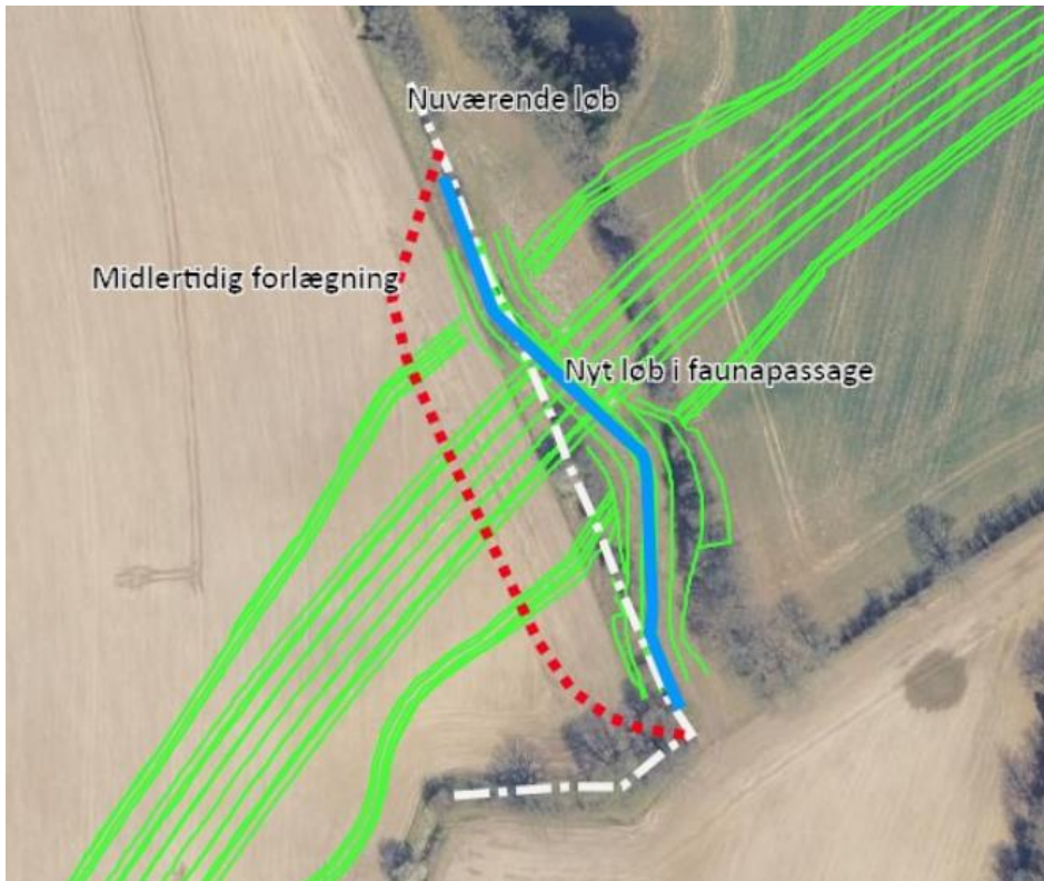
Figur 4: Midlertidig og permanent forlægning af Dalby Møllebæk. Den blå streg viser den permanente forlægning, hvor det nye forløb løber gennem en faunapassage. Den midlertidige forlægning (rød stiplede streg) bliver i form af en rørlægning af vandløbet. Den hvide streg markerer Dalby Møllebæks nuværende forløb.
