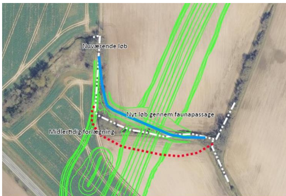
Figur 3: Midlertidig og permanent forlægning af Dalby Møllebæk. Den blå streg viser den permanente forlægning, hvor det nye forløb løber gennem en faunapassage. Den midlertidige forlægning (rød stiplede streg) bliver i form af en rørlægning af vandløbet. Den hvide streg markerer Dalby Møllebæks nuværende forløb.
