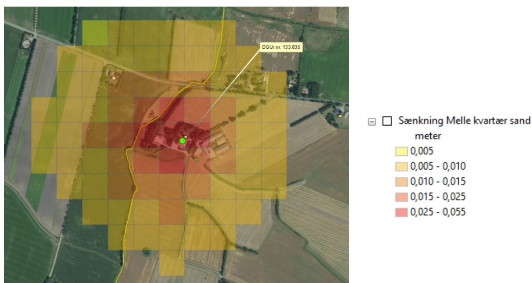
Figur 4 sænkning af grundvandsspejlet i grundvandsmagasinet "Mellem kvartær sand" ved indvinding fra boring DGU nr. 133.835. De grønne cirkler (markvanding) og gule firkanter (husholdning) viser andre boringer i området.
