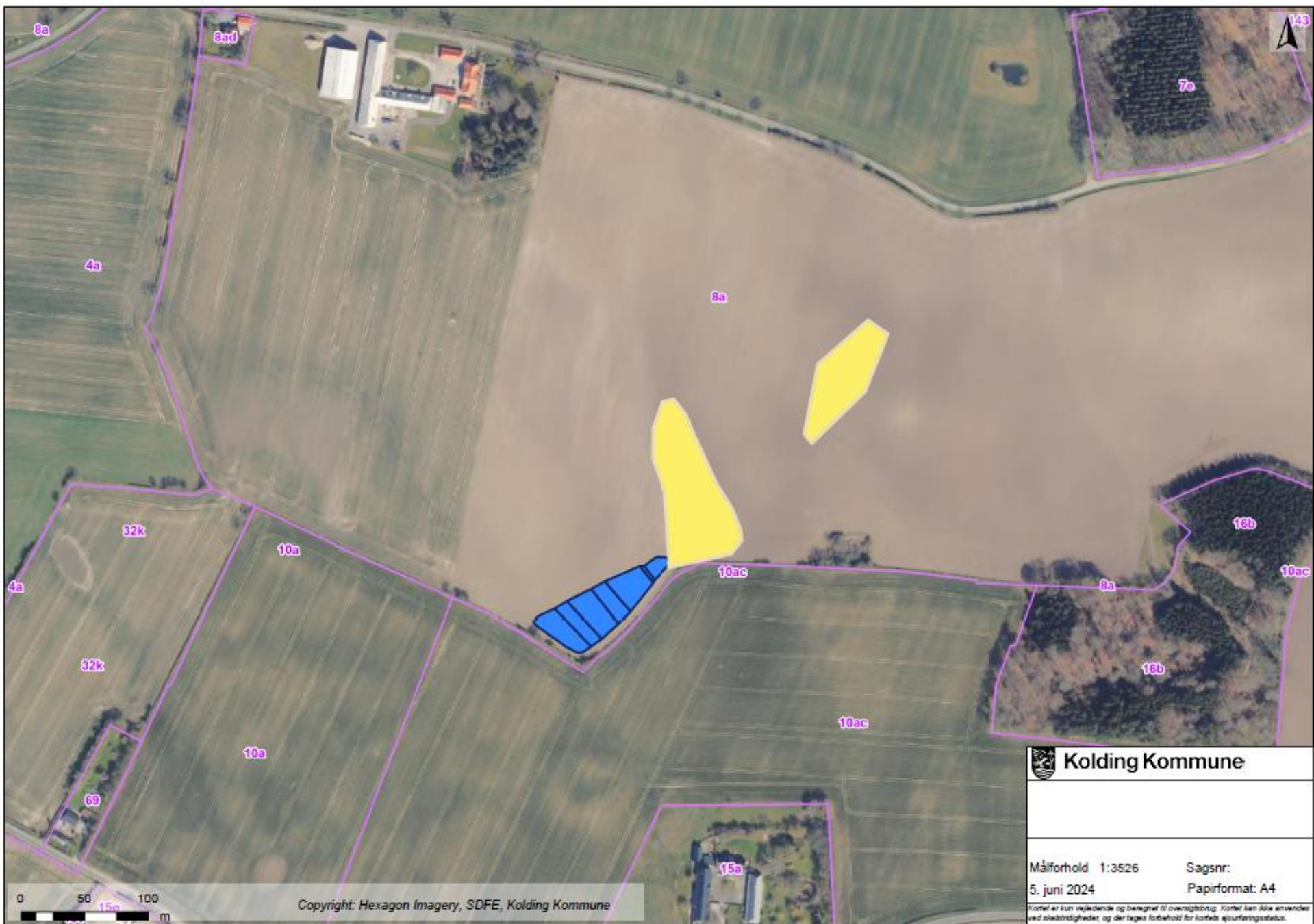
Kortbilag 2: Oversigtskort, der viser minivådområdets placering på matr.nr. 8a Sdr. Stenderup By, Sdr. Stenderup. Overskudsjorden fra anlægsarbejdet spredes ud indenfor den gule linje. Før udlægning afgraves muldjorden delvist (ca. 15 cm). Jorden lægges herefter ud i max 0,5 m. højde.
