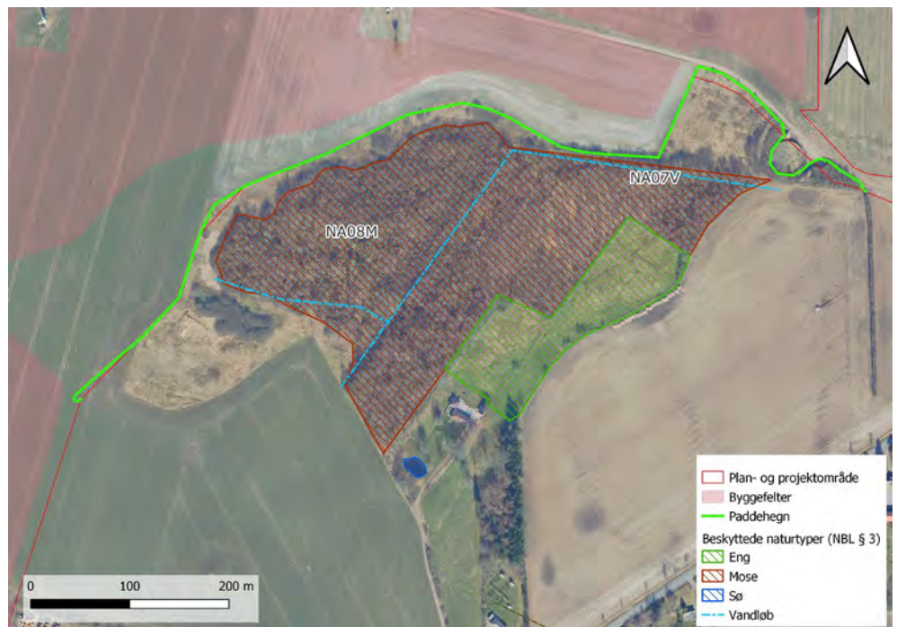
Figur 4-58 Lokaltitet NA08M (§ 3 beskyttet mose) med angivelse af principiel placering af paddehegn i anlægsfasen. Paddehegnet opstilles med "paddehop" på ydersiden med jævne mellemrum, således at padder kan hoppe ind over hegnet til søen, men ikke ud igen.
