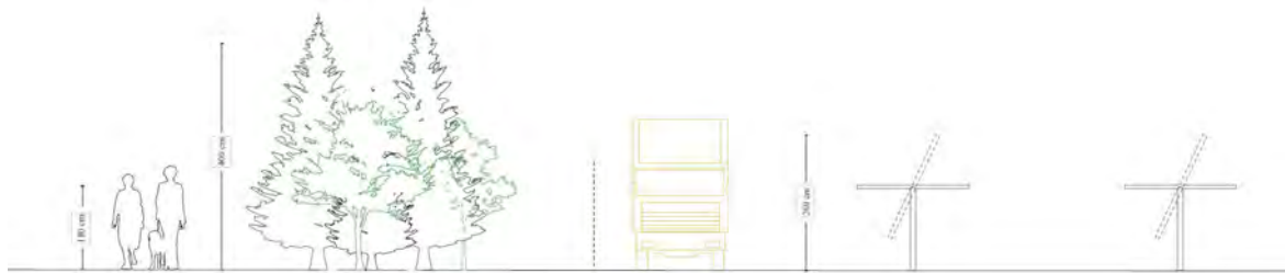
Figur 1-8 Principskitse for områdets afgrænsning med beplantningsbælte, intern servicevej og paneler på stativ.
