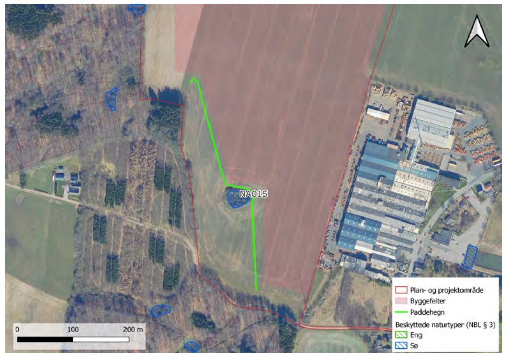
Figur 4-57 Lokaltitet NA01S (§ 3 beskyttet sø) med angivelse af principiel placering af paddehegn i anlægsfasen. Paddehegnet opstilles med "paddehop" på ydersiden to steder ved søen NA01S, således at padder kan hoppe ind over hegnet til søen, men ikke ud igen.
