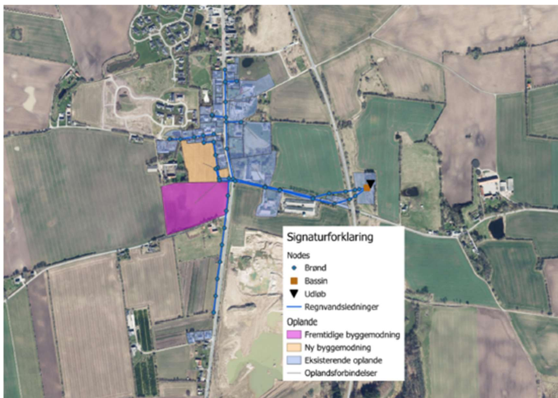
Figur 3: Kortudsnit fra ansøgning, hvor det eksisterende opland er angivet. Derudover er der angivet oplande fra den aktuelle ny byggemodning på matrikel 7r samt en fremtidig byggemodning jf. kommuneplanen.
