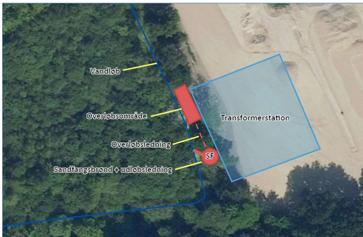
Figur 2: Skitsering af vandløb, transformerstation, sandfangsbrønd og overløbsområde.
