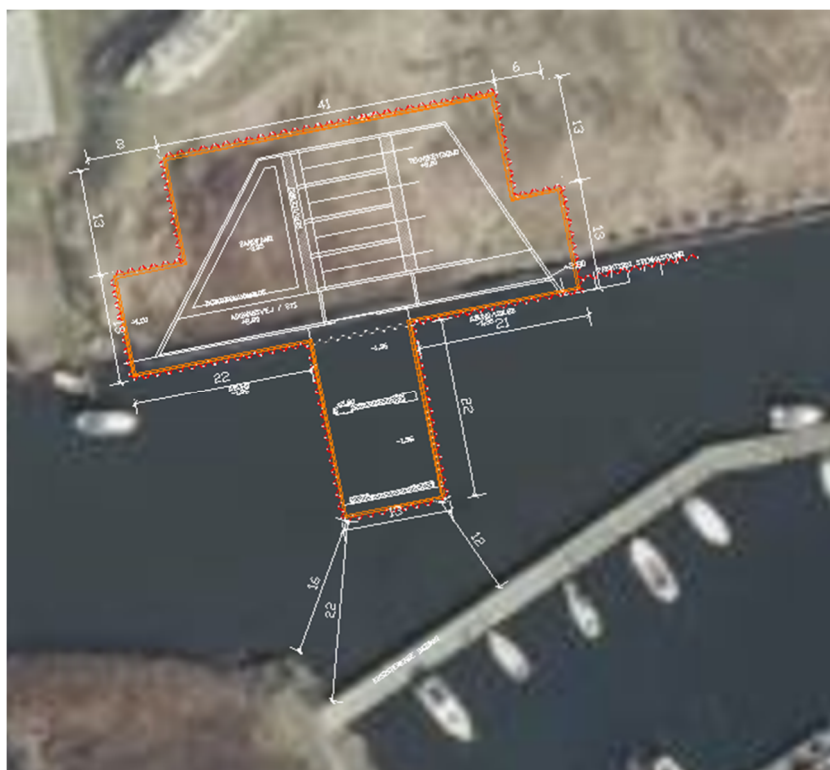
Figur 2-1 Afstande fra byggegrube til eksisterende bådebro og åbrink i den midlertidige fase.
