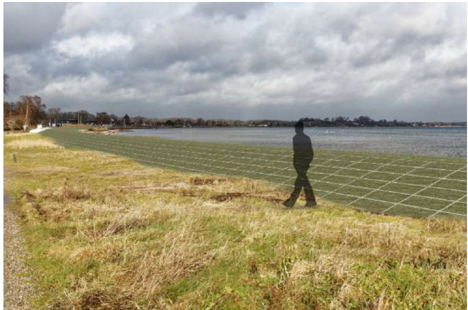
Figur 2.6: Visualisering af den alternative løsning med et lerdige.
